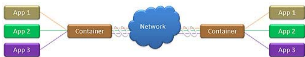
<그림 1> 컨테이너를 기반으로 한 AMS 시그널링 연결 구조
