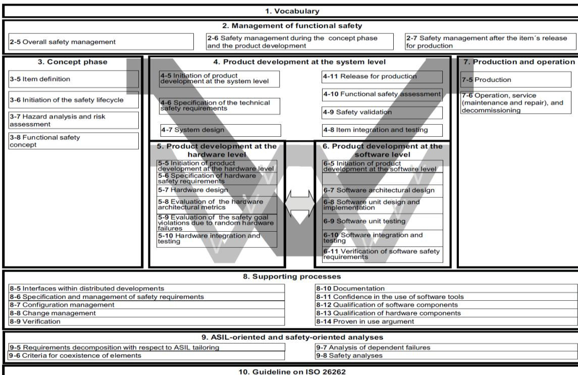
[그림 1] ISO 26262 자동차 기능안전 표준의 구성
