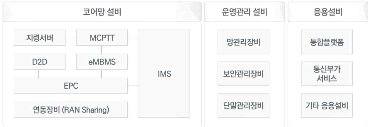
[그림 4] 재난안전통신망 테스트베드 구성도 (예시)
